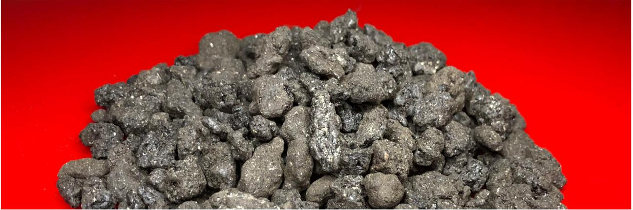
INNOFIX<sup>®</sup> MA ist ein, nach DIN EN 13108-6 geprüfter, Hochleistungs- Reparaturgussasphalt der sehr vielseitig einsetzbar ist und sich für den Einbau auf Straßen und sonstigen Verkehrsflächen eignet.
